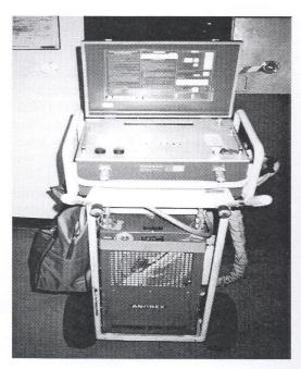
**Figura 2** - Aparelho de raios-X industrial, Andrex, Halfdansgade 8DK 2300, modelo CP 552, Copenhagen S - Dinamarca, capacidade para produzir 160kV, 10mA e tempo indeterminado de exposição, possuindo ainda potência constante
