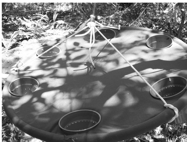
Figura 1 – “Armadilha de captura aérea” desenvolvida para coleta de artrópodes em copas
