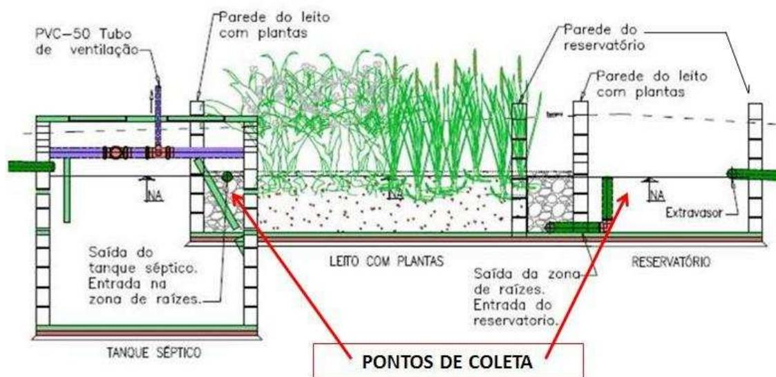
Figura 4: Vista em corte longitudinal do tanque sêptico e do reservatório do sistema residencial experimental de tratamento de esgoto avaliado, com indicação dos locais de coleta de amostras para análises laboratoriais. Goiânia, GO. 2008.
