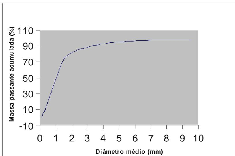
Figura 2: Distribuição granulométrica da areia utilizada no preenchimento do leito da zona de raízes do sistema residencial de tratamento de esgoto avaliado. Goiânia, GO. 2008.
