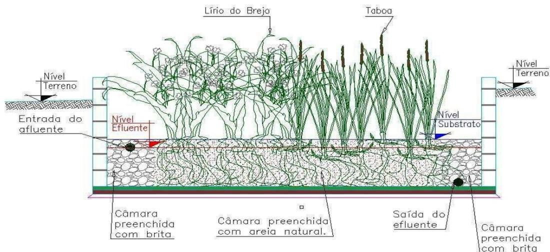
Figura 5 : Desenho esquemático de um corte longitudinal do leito da zona de raízes do sistema residencial experimental de tratamento de esgoto avaliado. Goiânia, GO, 2008.
