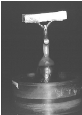
Figura 1 – Lâmina de acrílico presa a base formadora de cadinho, para futura fundição
