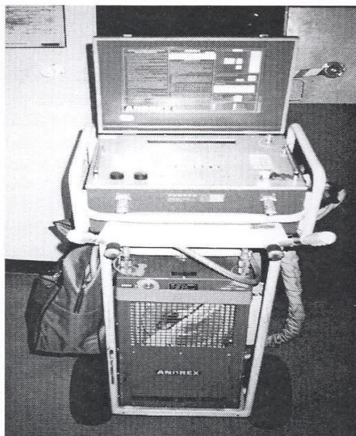
**Figura 2** - Aparelho de raios-X industrial, Andrex, Haldansgade 8DK 2300, modelo CP 552, Copenhagen S - Dinamarca, capacidade para produzir 160kV, 10mA e tempo indeterminado de exposição, possuindo ainda potência constante
