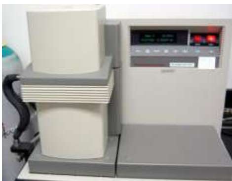
Figura 3. Equipamento TA Instruments acoplado a um termo-analisador, em ambiente de ar atmosférico, preparada para o ensaio de DMTA.
