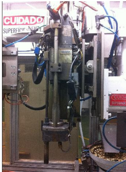
Figura 6. Sistema de insensor e aquecedor de buchas.
