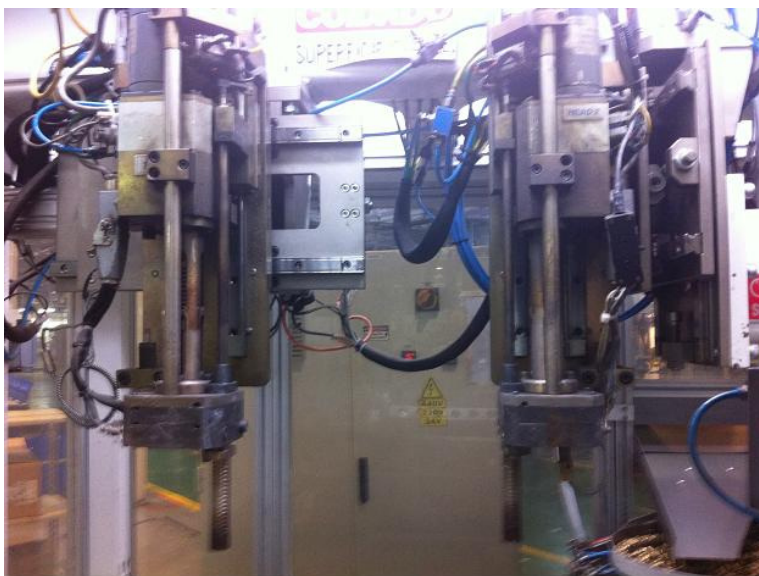
Figura 8. Sistema de inserção e aquecimento duplo.
