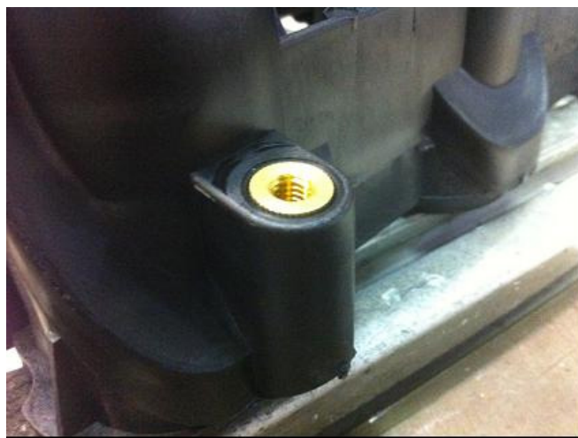
Figura 13. Bucha metálica inserida no alojamento vista de perfil.
