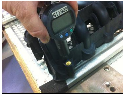
Figura 14. Método de medição da altura de inserção da bucha utilizando um relógio comparador.
