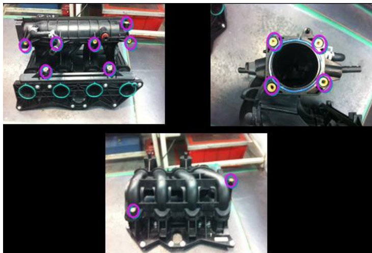
Figura 4. Localização das buchas metálicas no coletor de admissão.
