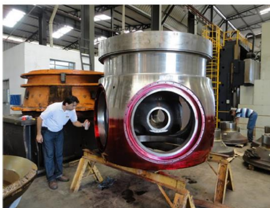
Figura 1 – Aplicação do líquido penetrante utilizando lata de aerossol.
