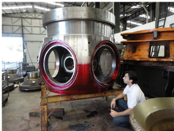
Figura 2 – Aguardando tempo de penetração do líquido.
