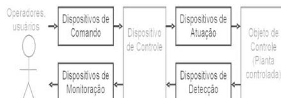
Fig. 1 – Sistema de automação.
