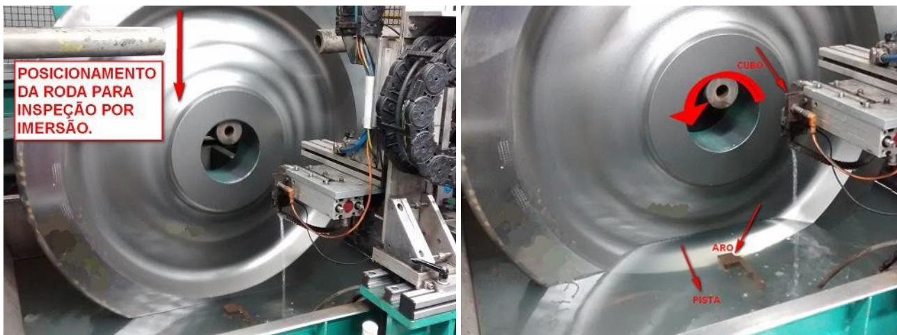
Figura 6 - Posicionamento da roda dentro do tanque de imersão e cabeçote no cubo da roda
