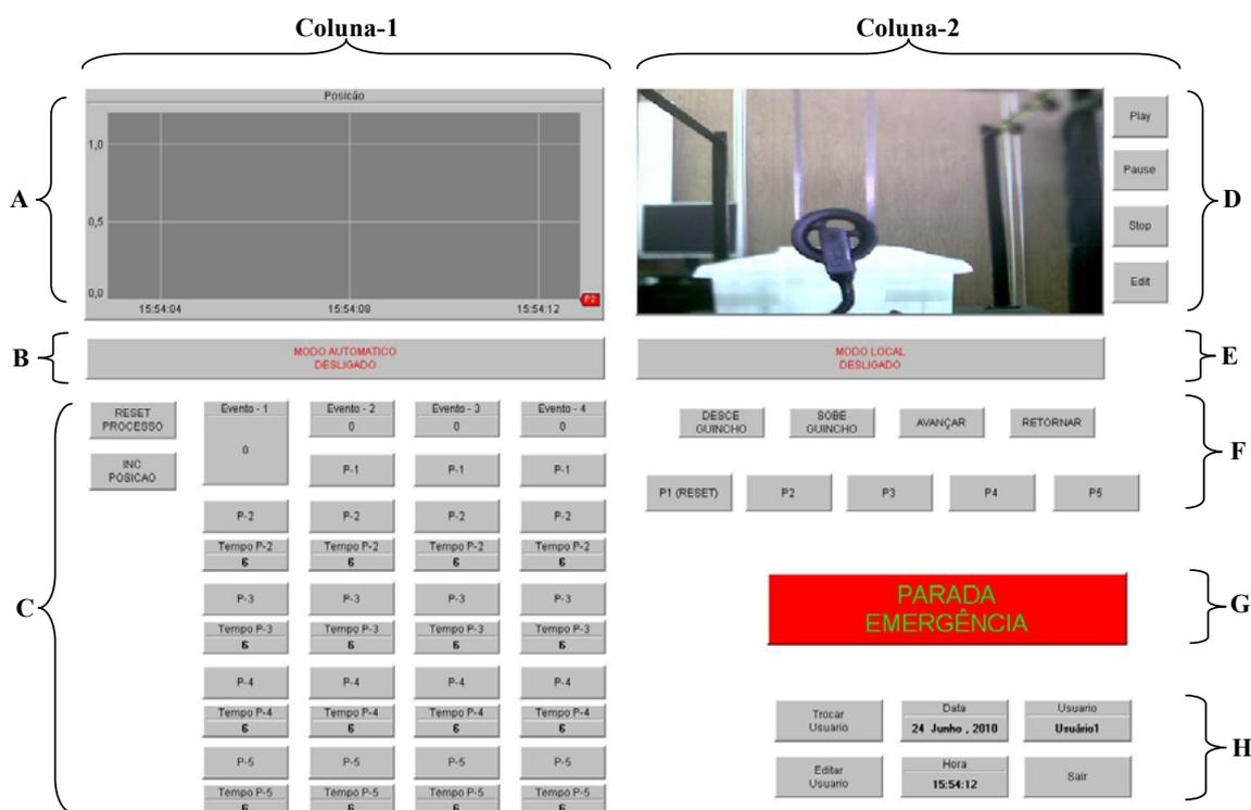
Na **Coluna-1**, da Figura 5, estão previstos os componentes gráficos que permitem ao operador identificar a posição do carro de movimentação (A), utilizar a operação em Modo Automático (B), parametrizar os tempos de tratamento de superfície (C, Tempo P-2, P-3, P-4 e P-5) e programar a sequência de banhos para o processo automático (C, P-1, P-2, P-3, P-4 e P-5)
