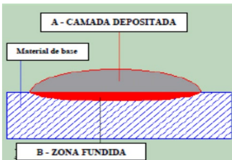
Figura 3 | Diluição em camada depositada
