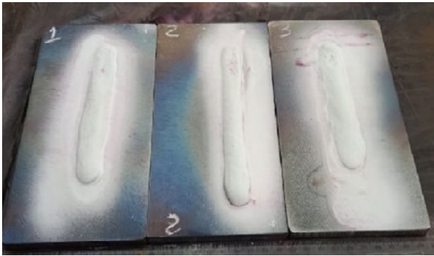
Figura 5 | Aplicação do revelador nas amostras soldadas
