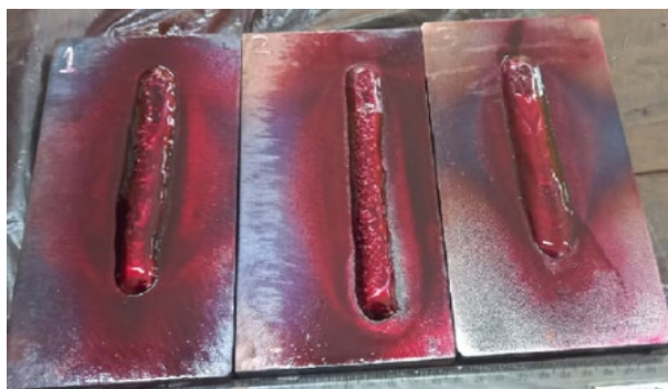
Figura 4 | Aplicação do líquido penetrante nas amostras
