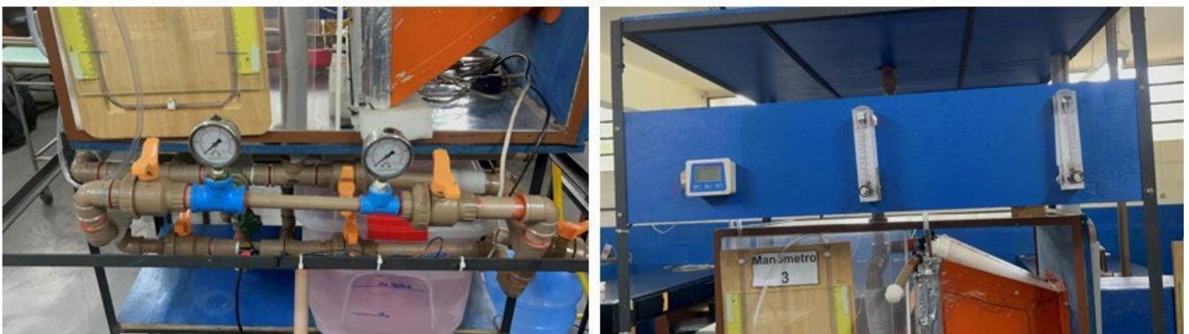
Figura 4 | Conjunto de rotâmetro e tubo de Venturi para medição redundante e precisa da vazão do fluido de arrefecimento.
