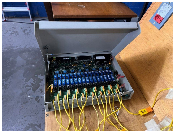
Figura 2 | Placa de aquisição de dados de alta resolução para monitoramento em tempo real das variáveis térmicas e fluidodinâmicas.
