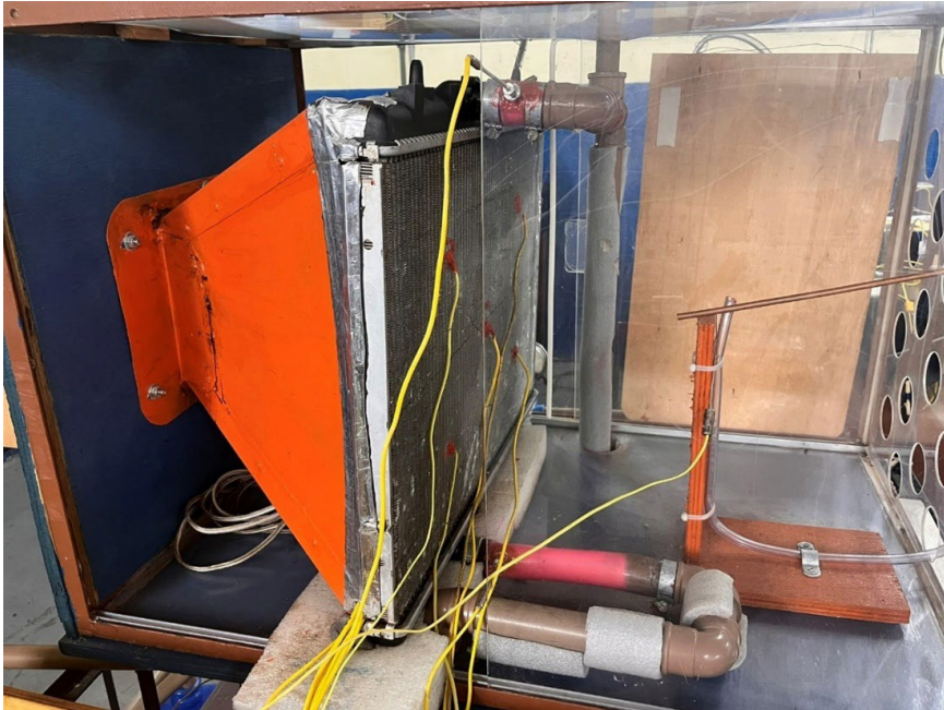
Figura 5 | Radiador automotivo com coifa de distribuição homogênea de ar e sensores para medição das temperaturas de entrada e saída do fluido e do ar.
