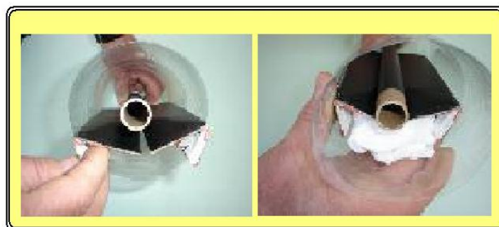
Figura 9. Posicionamento da caixa de leite pintada de preto dentro da garrafa PET. Fonte: José Alcino (2004).
